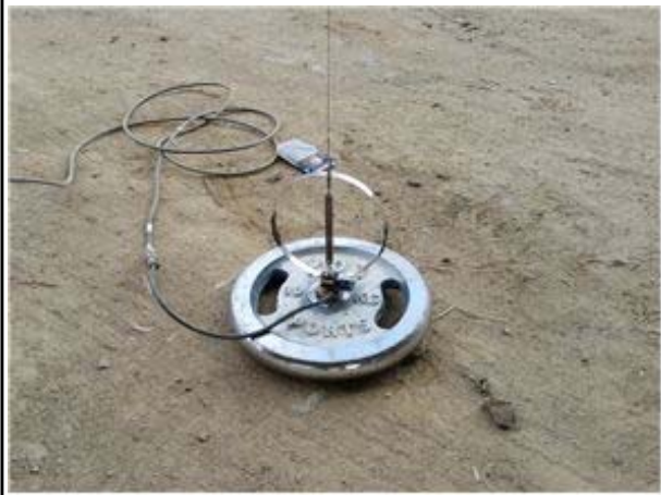
처짐계 설치 현황
