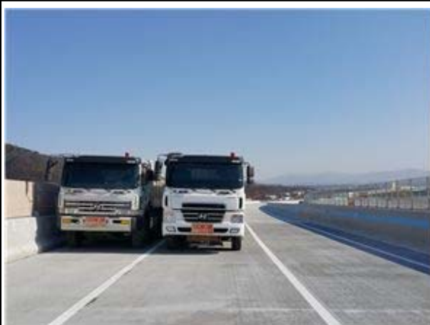
정적 재하시험 전경
