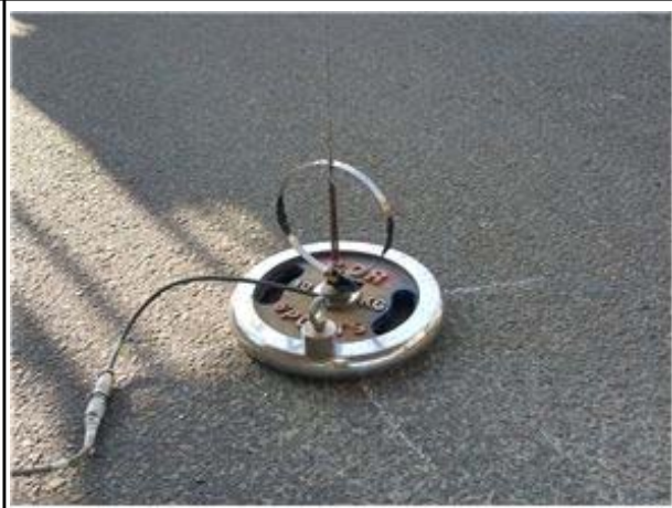
처짐계 설치 현황
