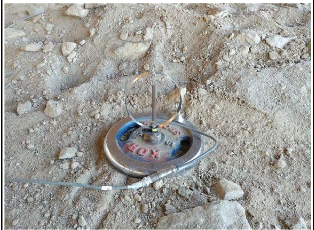
처짐계 설치 현황
