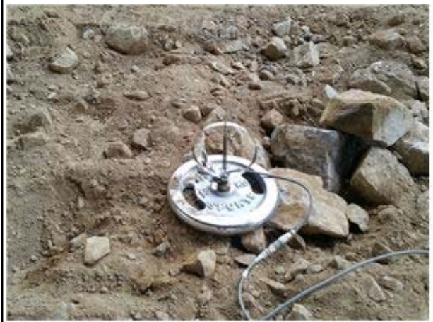
처짐계 설치 현황
