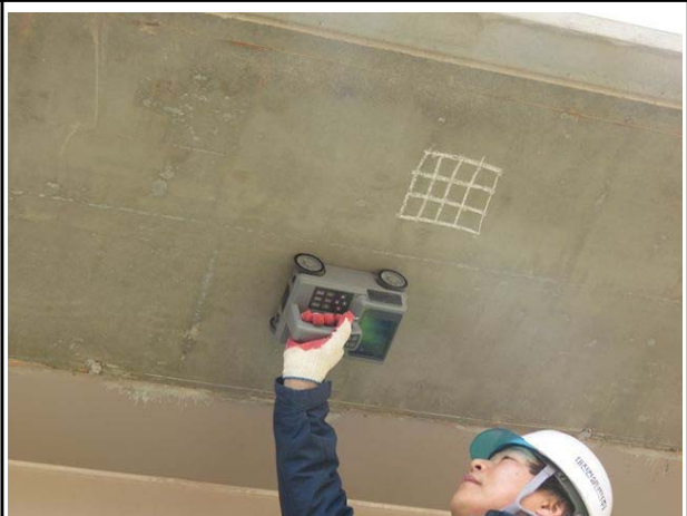
철근배근탐사 시험 전경
