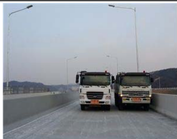
정적 재하시험 전경
