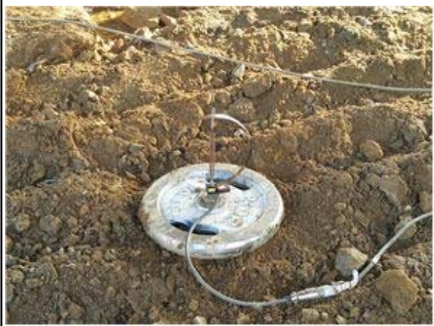
처짐계 설치 현황
